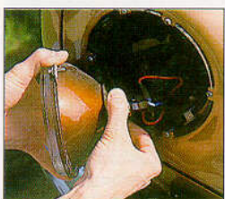
Les trois phases de l'extraction d'une lampe de phare.
