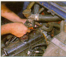
Vérifier le serrage des colliers de durits tout en traquant les éventuelles fuites.
